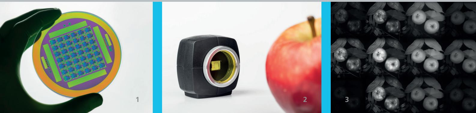
1 Filter-Array-Wafer mit lateral strukturierten Filter-Kacheln.
