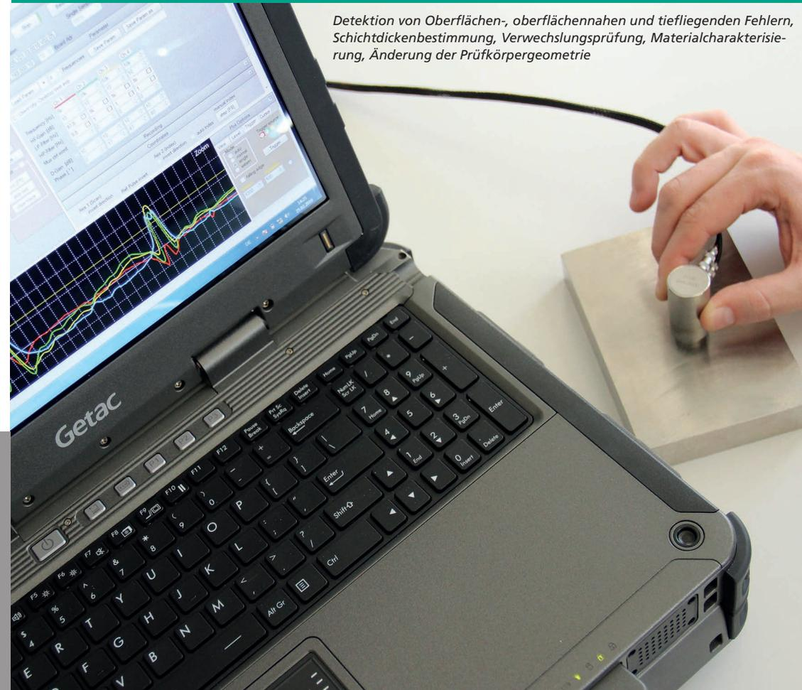
*Detektion von Oberflächen-, oberflächennahen und tiefliegenden Fehlern, Schichtdickenbestimmung, Verwechslungsprüfung, Materialcharakterisierung, Änderung der Prüfkörpergeometrie*
